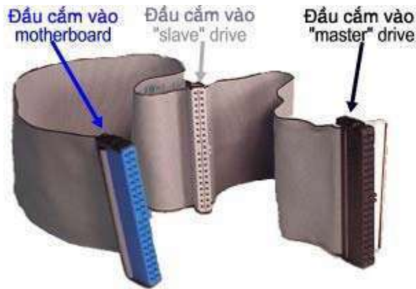
Chiều đầu dây cáp tín hiệu giữa ổ và máy
