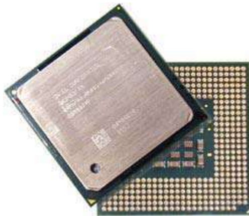
CPU cho máy Pentium 4 Socket 478
