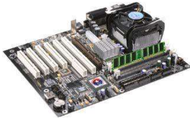
Lắp CPU và RAM vào Mainboard từ bên ngoài
