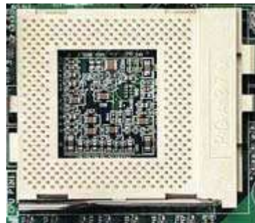
Để cắm CPU - Socket 370 trên các Mainboard Pentium 3
