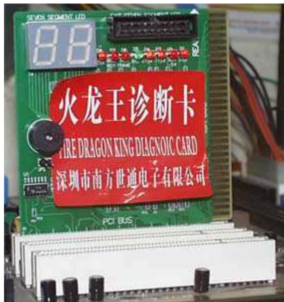
Gắn Card Test Main vào khe PCI
