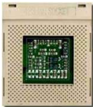
Đế cắm CPU - Socket 423 trong các máy Pentium 4 đời đầu
