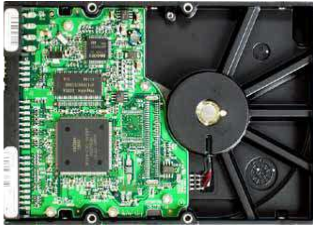
Mạch điều khiển nằm phía sau ổ cứng
