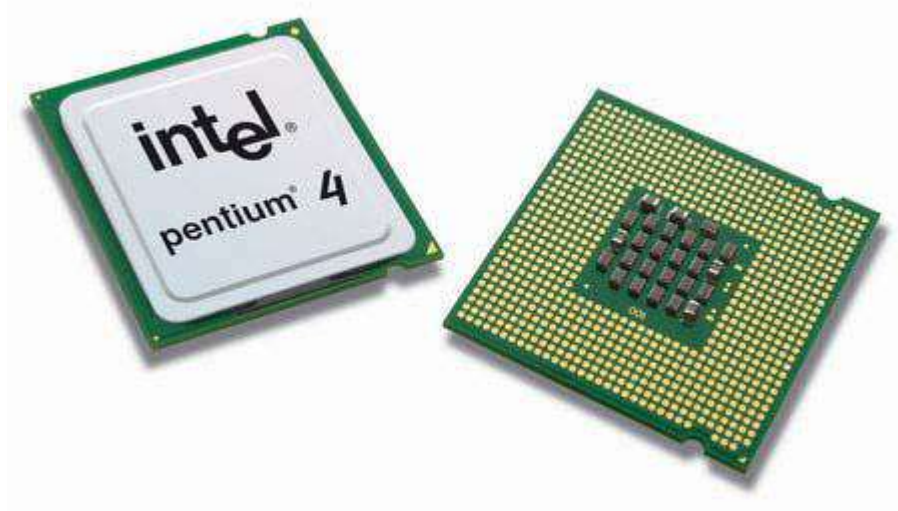
CPU cho các máy Pentium 4 Socket 775 phân biệt bằng hai khuyết hình bán nguyệt ở cạnh và không có chân
