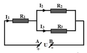
**Bài 4.** Cho mạch điện có sơ đồ như hình 6.6, trong đó các điện trở  $R_1=14\Omega$ ;  $R_2=8\Omega$ ;  $R_3=24\Omega$ ; dòng điện đi qua  $R_1$  có cường độ là  $I_1=0,4A$
